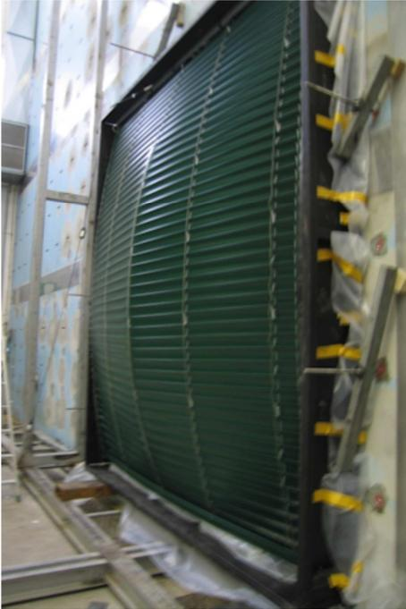
**Figura 1. Campione durante la prova al carico di vento.**
