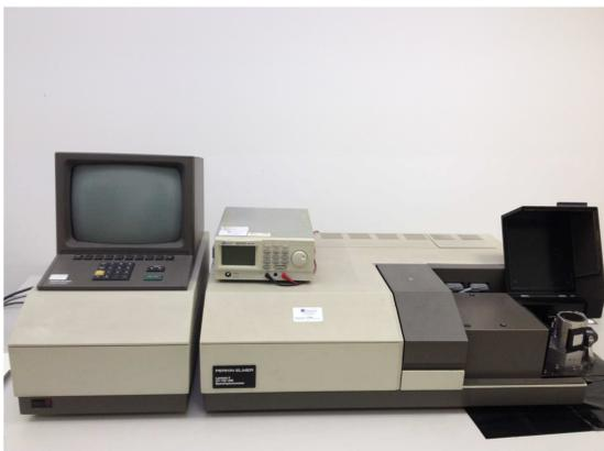
Figura 2. Spettrofotometro Perkin Elmer Lambda 9 per l'effettuazione delle caratteristiche ottiche nel range solare
